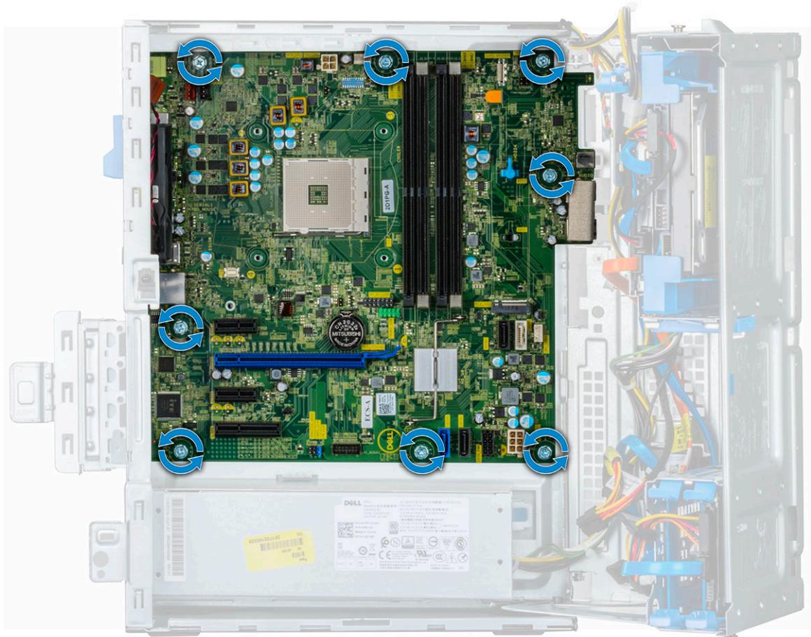
b) Schieben und heben Sie die Systemplatine aus dem Computer [2].
