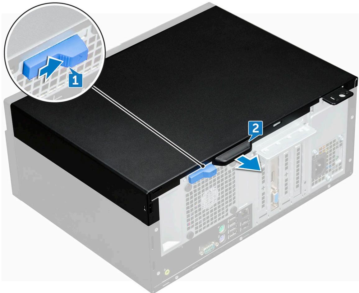
3. Heben Sie die Seitenabdeckung an, um sie vom Computer zu entfernen.
