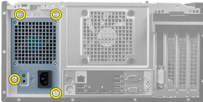
5. Drücken Sie auf die blaue Freigabelasche neben dem Netzteil und schieben Sie das Netzteil in Richtung der Computervorderseite. Heben und entfernen Sie das Netzteil aus dem Computer.
