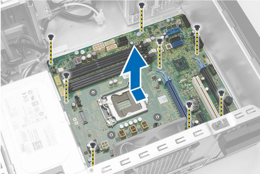
5. Winkeln Sie die Systemplatine um 45 Grad an und heben Sie sie dann aus dem Computer.
