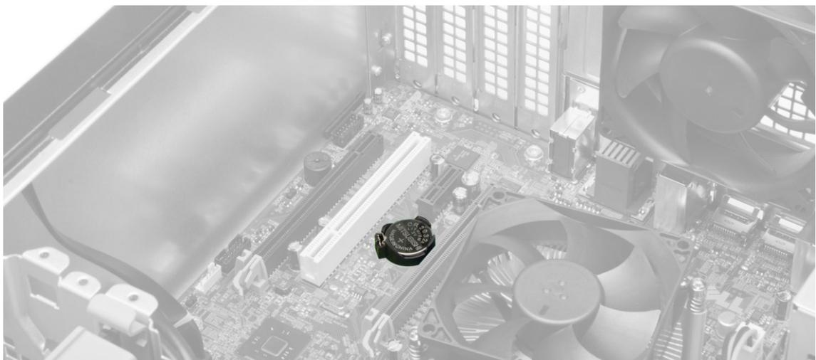
4. Drücken Sie den Lösehebel von der Batterie weg, damit sie aus der Buchse springt und nehmen Sie die Knopfzelle aus dem Computer.
