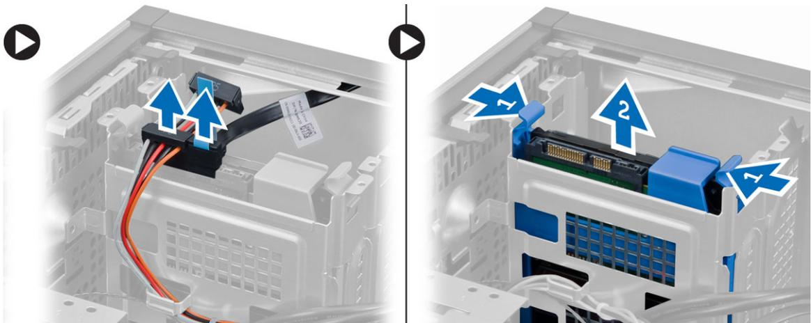
4. Biegen Sie die Festplattenlaufwerkhalterung und nehmen Sie das Festplattenlaufwerk heraus.
