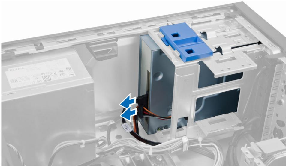
4. Schieben Sie den Riegel des optischen Laufwerks und halten Sie ihn fest, um das optische Laufwerk zu entriegeln, und ziehen Sie das optische Laufwerk aus dem Computer.
