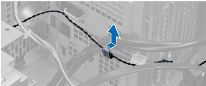
5. Drücken Sie von beiden Seiten auf die Laschen, um den Temperatursensor zu lösen und aus dem Gehäuse zu entfernen.
