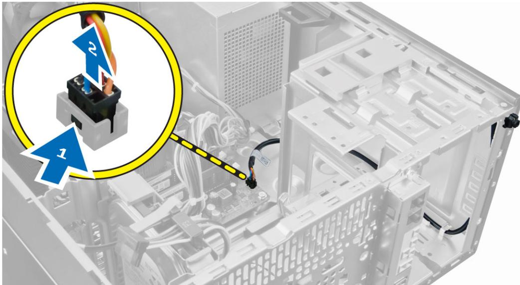
4. Lösen Sie das Betriebsschalterkabel aus den Gehäuseklammern.
