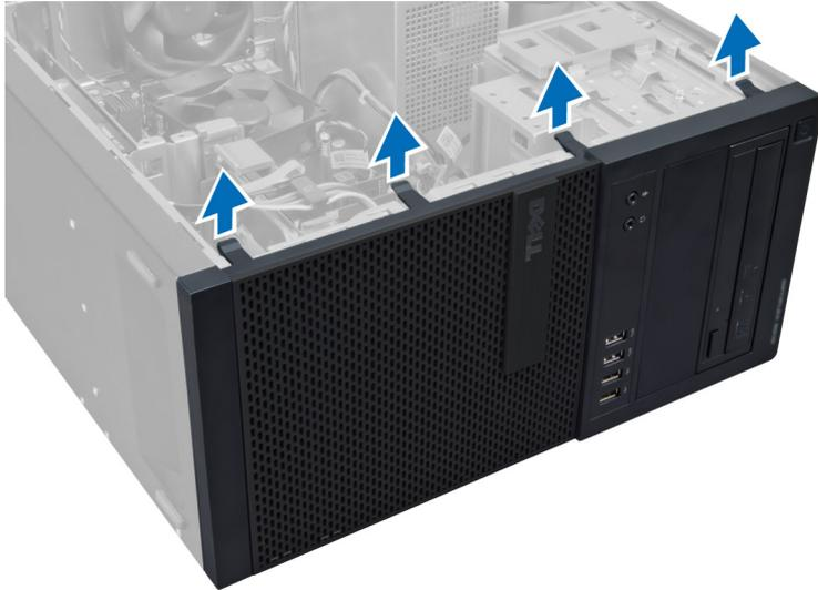
4. Drehen Sie die Frontverkleidung seitlich vom Computer weg, um die Haken auf der gegenüberliegenden Seite der Verkleidung aus dem Gehäuse zu entfernen.
