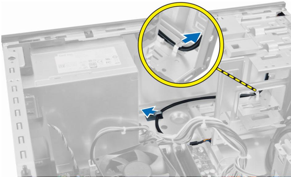
5. Drücken Sie die auf die Klammern an beiden Seiten des Betriebsschalters, um diesen vom Gehäuse zu lösen, und schieben Sie den Betriebsschalter zusammen mit seinem Kabel aus dem Computer.
