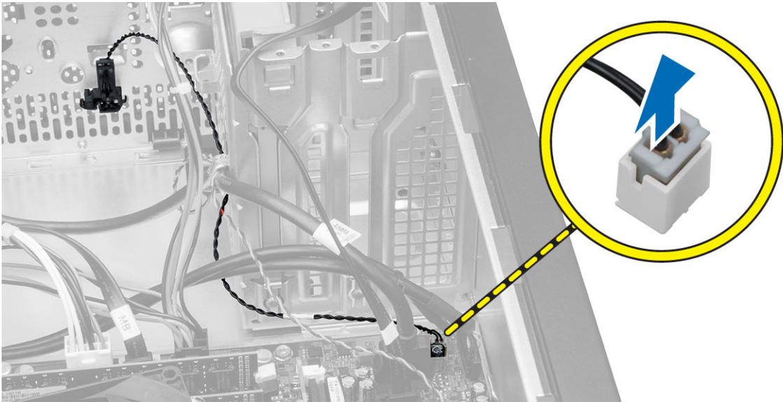
4. Lösen Sie das Kabel des Temperatursensors aus der Gehäuseklammer.
