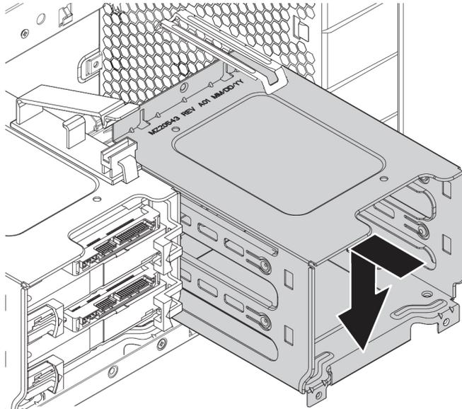
Abbildung 75. Speicherlaufwerkhalterung installieren
