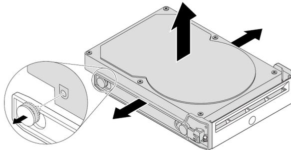
Abbildung 17. Das 3,5-Zoll-Speicherlaufwerk aus der Halterung entfernen
