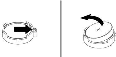
Abbildung 124. Knopfzellenbatterie entfernen
