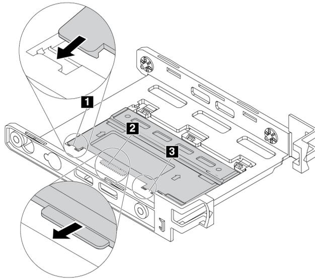
Abbildung 61. Einsetzen der Laschen in die entsprechenden Steckplätze
