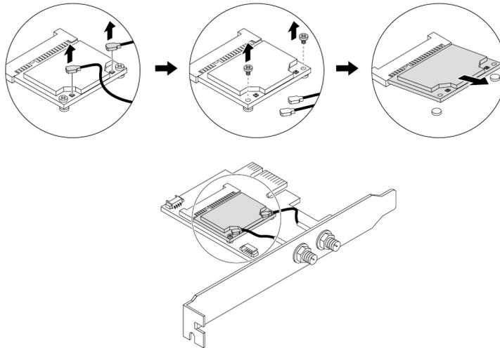
Abbildung 130. Wi-Fi-Karte entfernen
