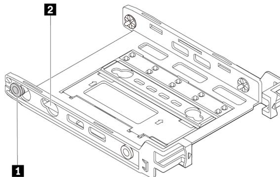
Abbildung 66. Stift entfernen und im neuen Steckplatz installieren
