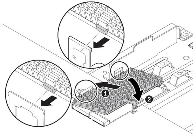
Abbildung 88. Installieren des Kühlkörpers an der Systemplatine
