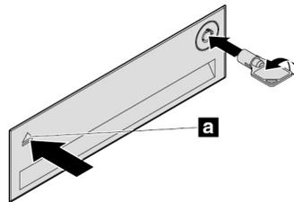
Abbildung 15. Abdeckung des Gehäuses mit Frontzugriff für die Speichereinheit öffnen
