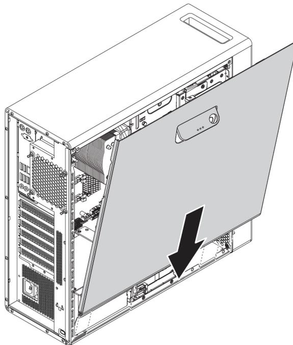
Abbildung 134. Computerabdeckung positionieren
