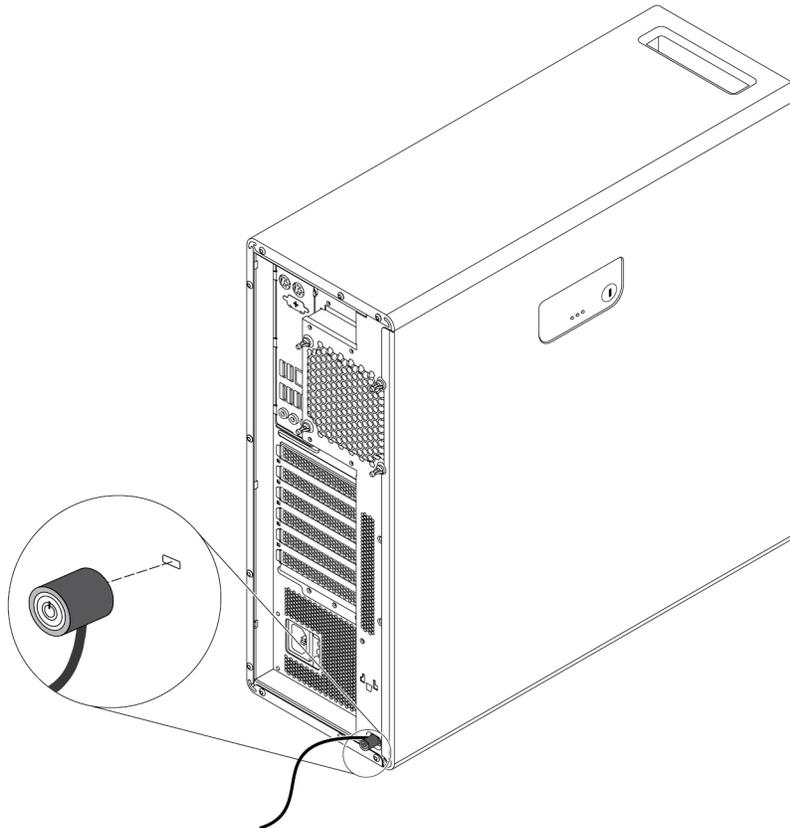
Abbildung 8. Kabelverriegelung (Kensington-Schloss)
