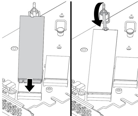
Abbildung 96. M.2-Solid-State-Laufwerk installieren
