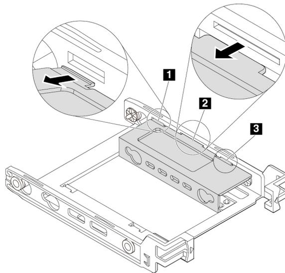
Abbildung 38. Lösen der Laschen aus den entsprechenden Steckplätzen
