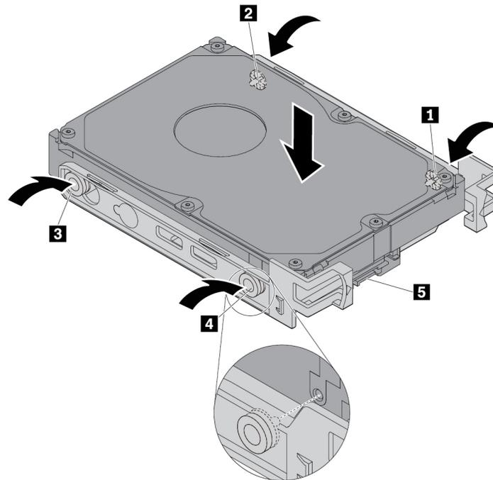
Abbildung 62. Installieren des neuen 3,5-Zoll-Speicherlaufwerks in der Halterung
