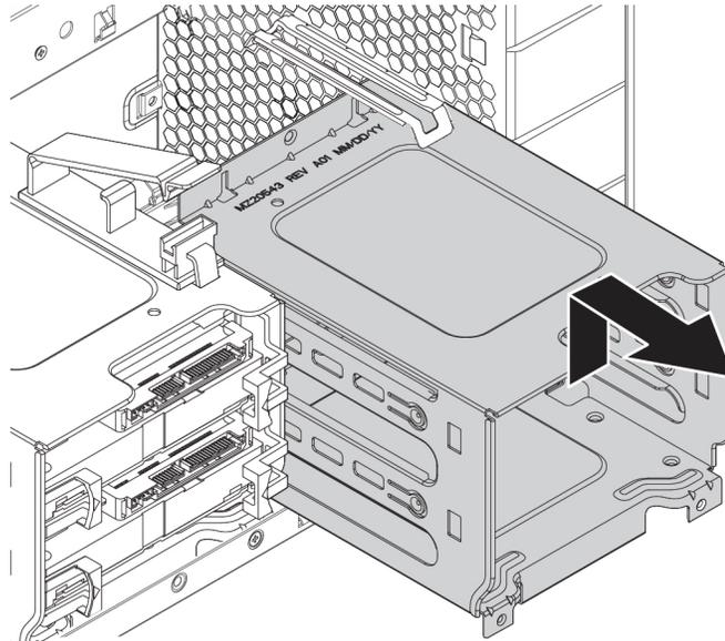
Abbildung 73. Speicherlaufwerkhalterung entfernen
