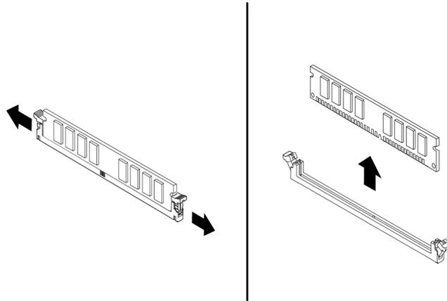
Abbildung 121. Speichermodul entfernen
