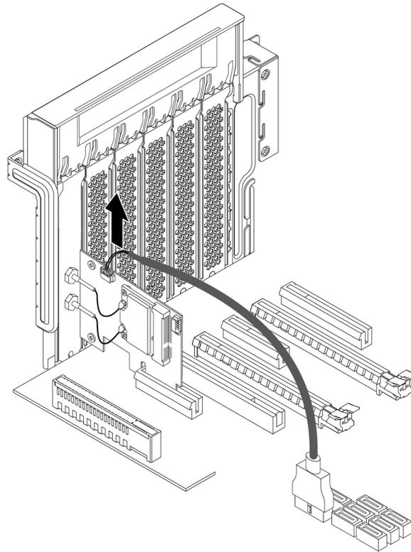
Abbildung 127. Bluetooth-Kabel abziehen
