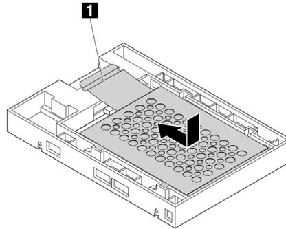
Abbildung 27. Metallhalterung im Kunststoffrahmen des Konverters installieren
