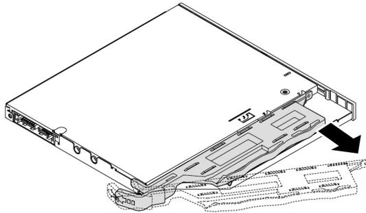
Abbildung 31. Halterung vom flachen optischen Laufwerk entfernen
