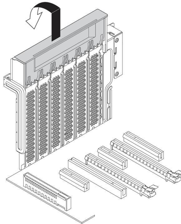
Abbildung 106. PCIe-Kartenverriegelung öffnen
