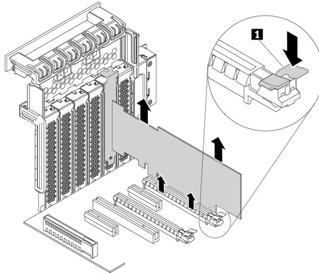
Abbildung 105. PCIe-Karte entfernen
