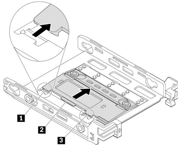
Abbildung 48. Halterung drehen
