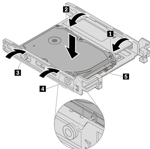
Abbildung 51. Installieren des neuen 2,5-Zoll-Speicherlaufwerks in der Halterung
