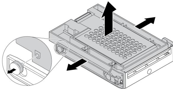
Abbildung 22. Das 2,5-Zoll-Speicherlaufwerk aus der Halterung entfernen
