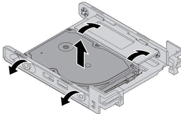
Abbildung 65. Entfernen des Speicherlaufwerks aus der Adapterhalterung
