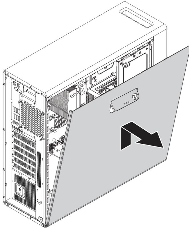
Abbildung 10. Computerabdeckung entfernen
