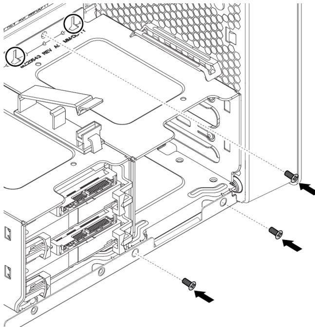
Abbildung 76. Befestigen der Speicherlaufwerkhalterung mit drei Schrauben
