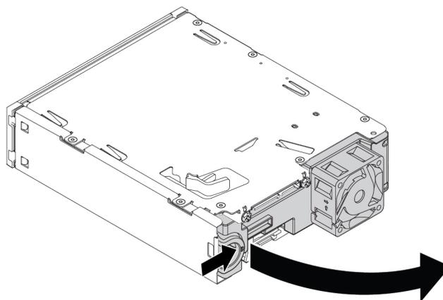
Abbildung 44. Öffnen der hinteren Abdeckung des Kits
