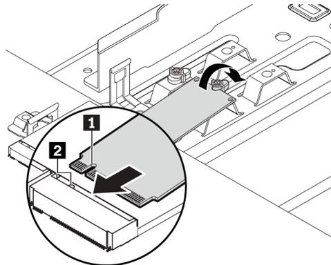
Abbildung 86. M.2-Solid-State-Laufwerk installieren
