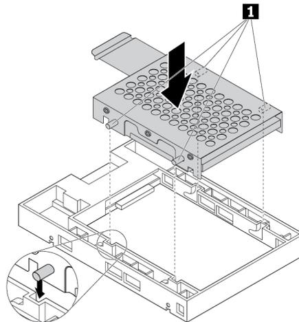
Abbildung 26. Metallhalterung in den Kunststoffrahmen des Konverters einsetzen
