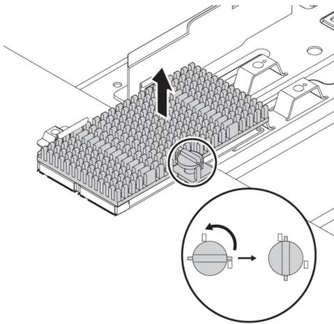
Abbildung 83. Kühlkörper entfernen
