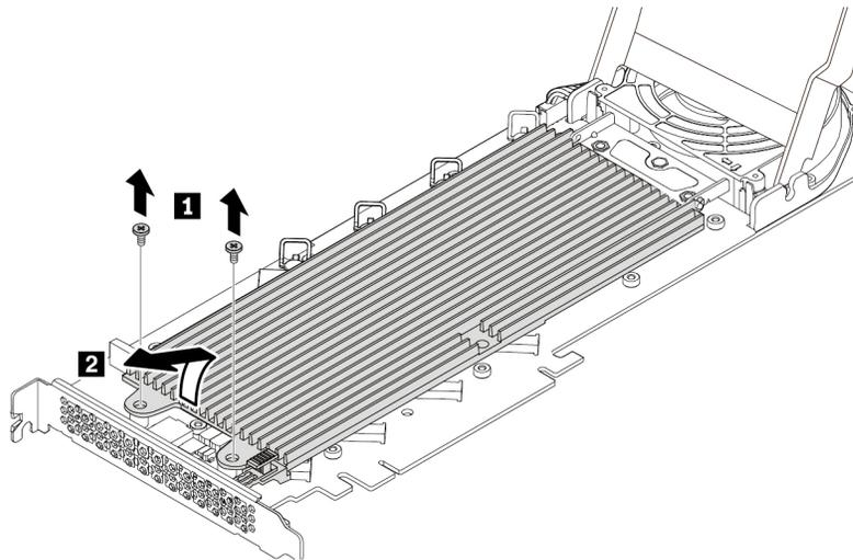
Abbildung 92. Kühlkörper entfernen
