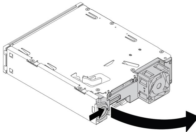
Abbildung 34. Öffnen der hinteren Abdeckung des Kits
