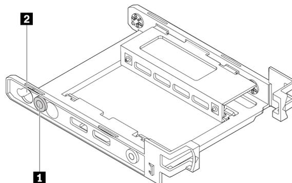
Abbildung 58. Stift entfernen und im neuen Steckplatz installieren
