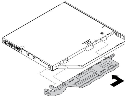
Abbildung 32. Halterung am neuen flachen optischen Laufwerk anbringen
