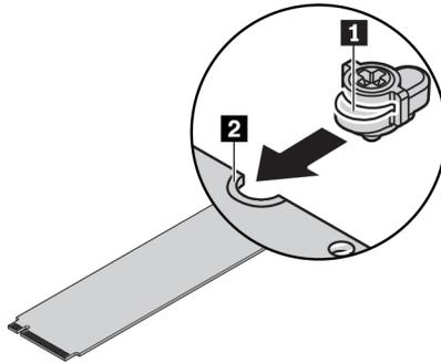
Abbildung 85. Anbringen des Schraubenhalters auf dem M.2 Solid-State-Laufwerk
