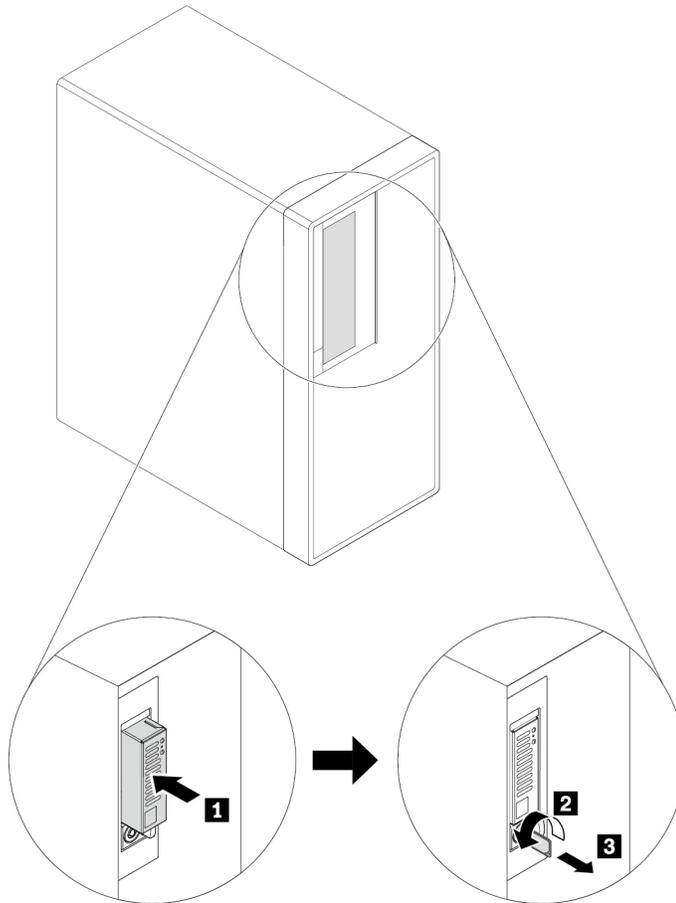
Abbildung 82. Erneutes Installieren des Trägers des M.2-Solid-State-Laufwerks
