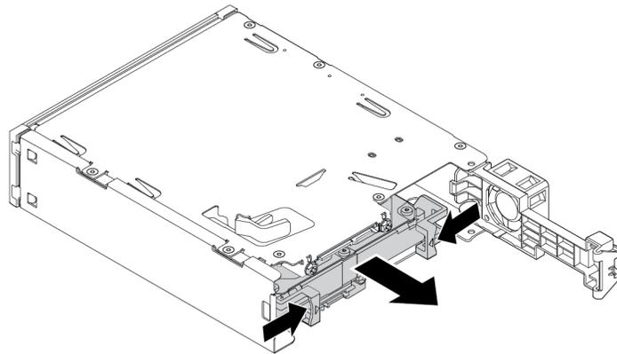
Abbildung 35. Entfernen der Adapterhalterung aus dem Kit
