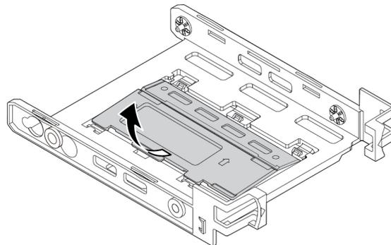
Abbildung 68. Halterung nach oben klappen
