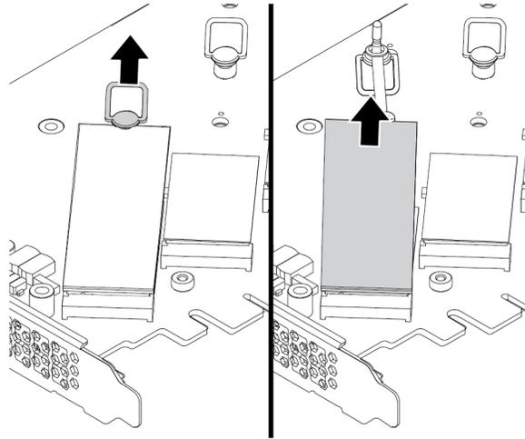
Abbildung 93. M.2-Solid-State-Laufwerk entfernen
