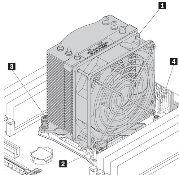
Abbildung 111. Kühlkörper- und Lüftungsbaugruppe entfernen
