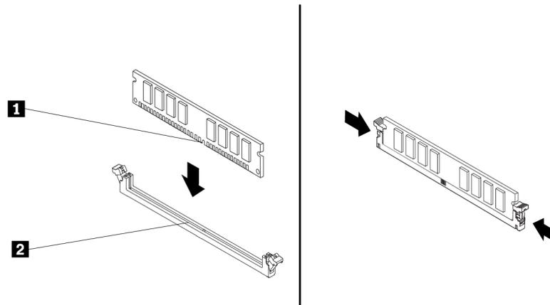
Abbildung 123. Speichermodul installieren
