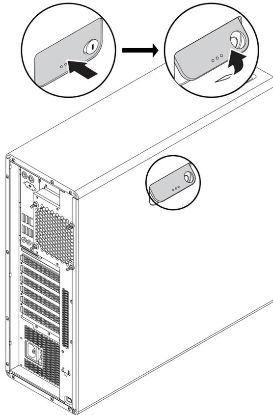
Abbildung 9. Öffnen des Griffs auf der Computerabdeckung
