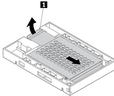
Abbildung 23. Metallhalterung vom Kunststoffrahmen des Konverters entfernen
