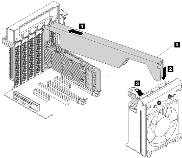
Abbildung 115. Superkondensatormodul installieren
