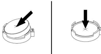
Abbildung 125. Installieren einer Knopfzellenbatterie
