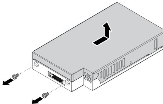
Abbildung 78. Entfernen der Abdeckung vom Träger des M.2-Solid-State-Laufwerks
