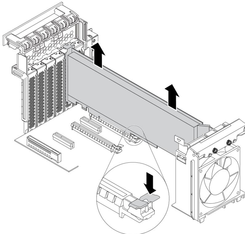
Abbildung 110. Lange PCIe-Karte entfernen
