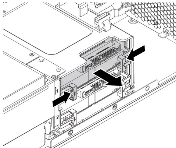
Abbildung 56. Entfernen der Adapterhalterung
