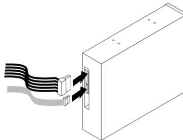
Abbildung 14. Kabel an das optische Laufwerk anschließen
