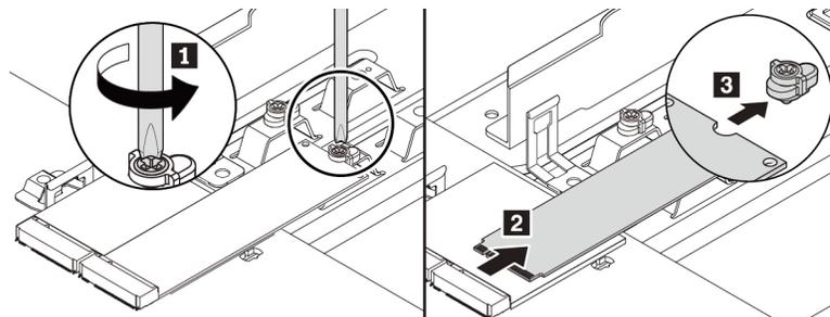
Abbildung 84. M.2-Solid-State-Laufwerk entfernen
