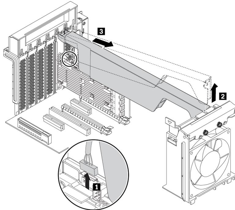
Abbildung 113. Superkondensatormodul entfernen
