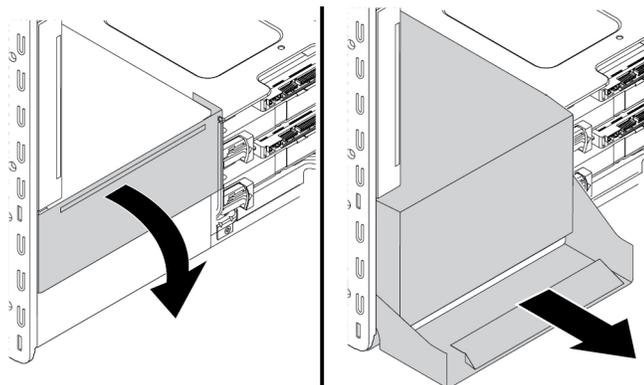
Abbildung 99. Netzteil entfernen
