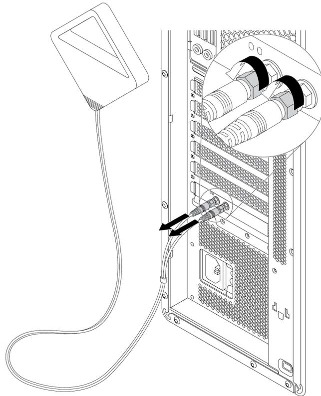
Abbildung 126. Wi-Fi-Antenne entfernen
