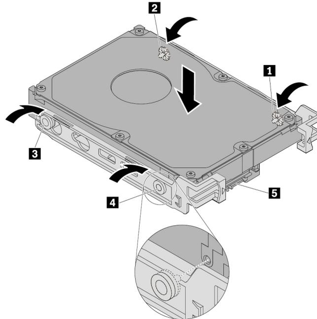
Abbildung 41. Installieren des neuen 3,5-Zoll-Speicherlaufwerks in der Halterung
