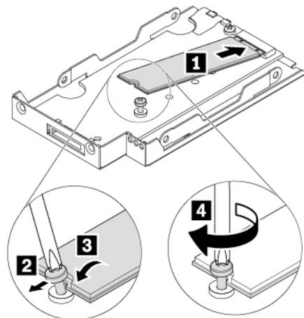
Abbildung 80. M.2-Solid-State-Laufwerk installieren
