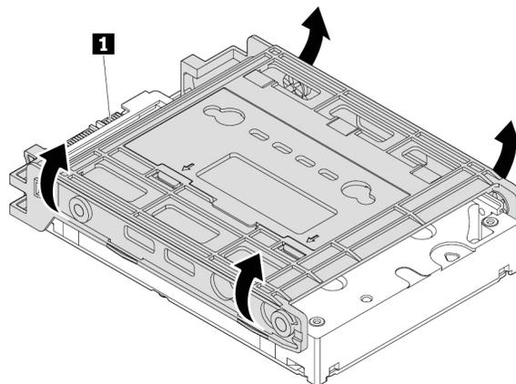
Abbildung 36. Entfernen des 3,5-Zoll-Speicherlaufwerks aus der Adapterhalterung
