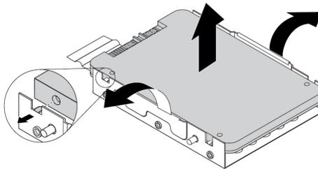
Abbildung 24. Entfernen des Speicherlaufwerks aus der Metallhalterung
