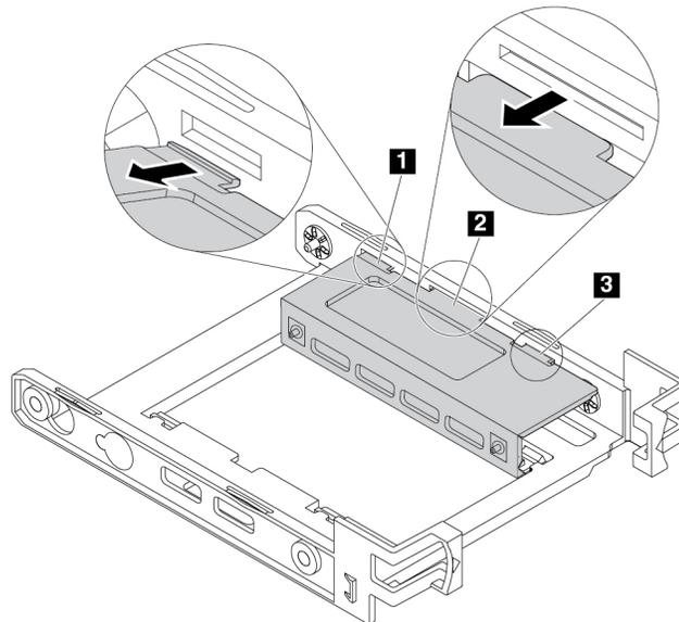
Abbildung 59. Lösen der Laschen aus den entsprechenden Steckplätzen
