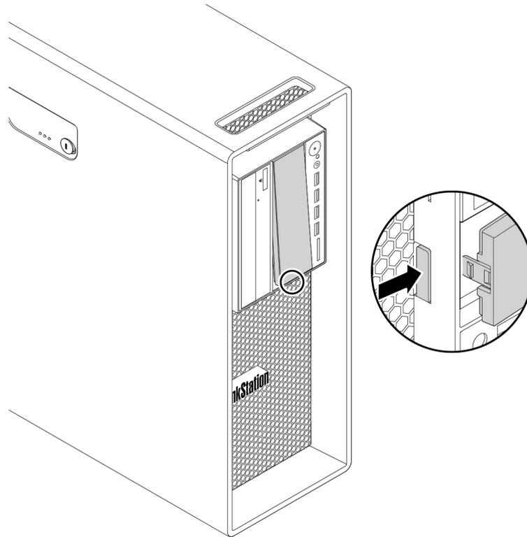
Abbildung 12. Kunststoffblende in der Flex-Position entfernen
