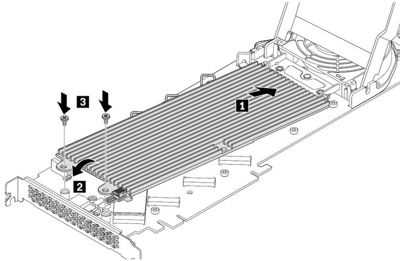
Abbildung 97. Installation des Kühlkörpers am PCIe-Adapter
