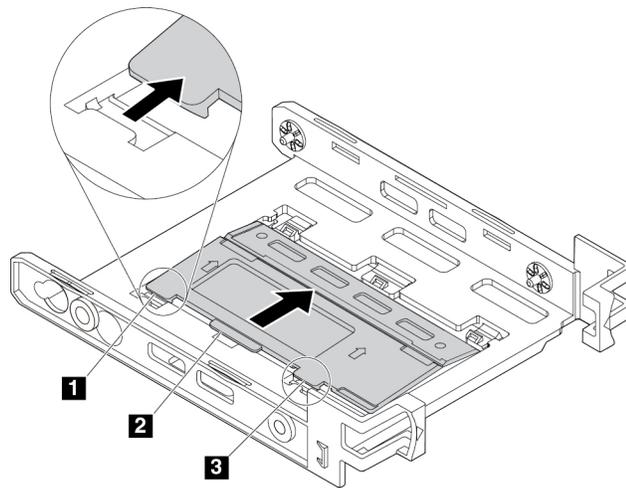
Abbildung 67. Halterung drehen
