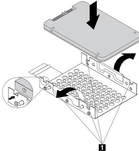
Abbildung 25. Installieren des 2,5-Zoll-Speicherlaufwerks in der Metallhalterung
