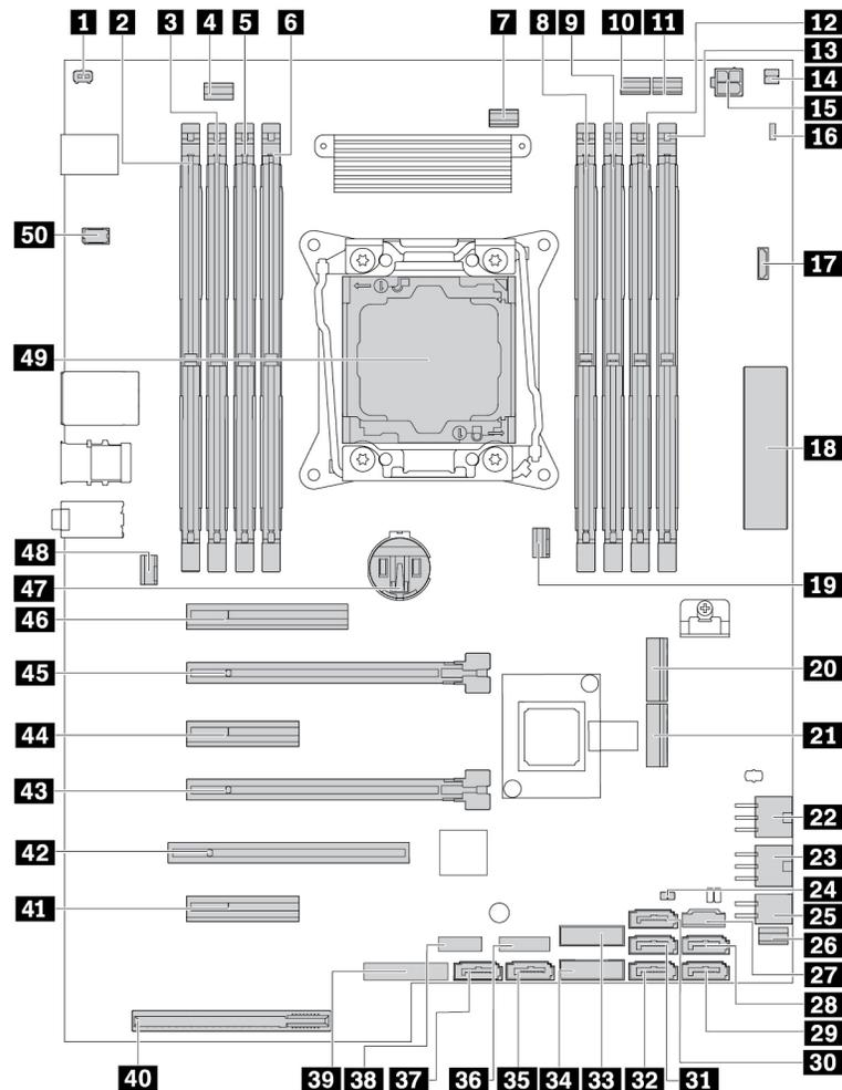
Abbildung 4. Positionen der Komponenten auf der Systemplatine
