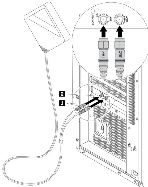
Abbildung 133. Wi-Fi-Antenne anbringen
