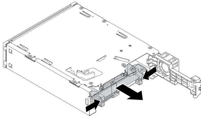
Abbildung 45. Entfernen der Adapterhalterung aus dem Kit
