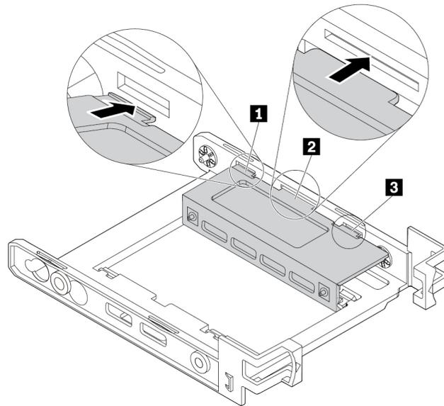
Abbildung 69. Einsetzen der Laschen in die entsprechenden Steckplätze
