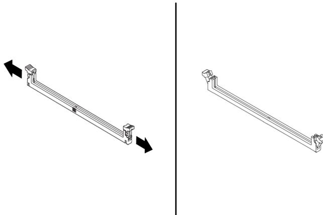
Abbildung 122. Halteklammern öffnen
