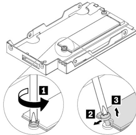
Abbildung 79. M.2-Solid-State-Laufwerk entfernen
