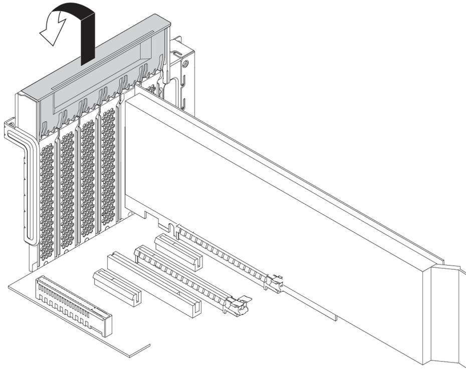
Abbildung 108. PCIe-Kartenverriegelung öffnen
