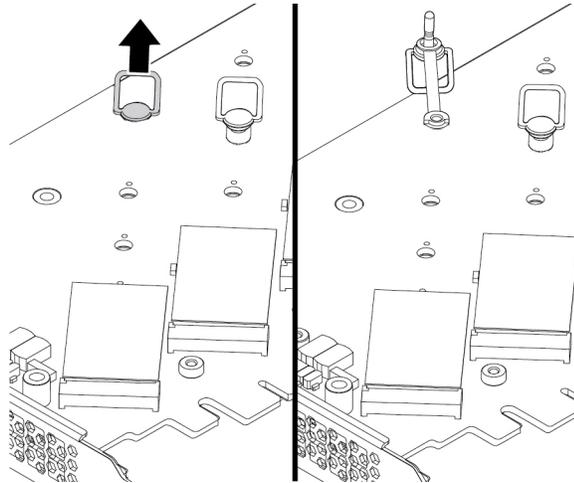
Abbildung 95. Öffnen der Sicherung
