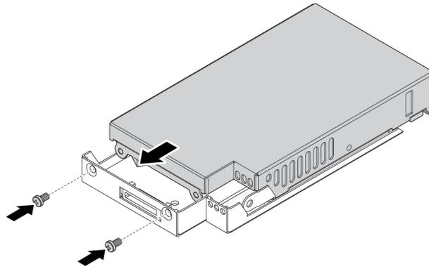
Abbildung 81. Installieren der Abdeckung am Träger des M.2-Solid-State-Laufwerks
