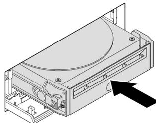
Abbildung 19. Installieren des 3,5-Zoll-Speicherlaufwerks im Gehäuse mit Frontzugriff für die Speichereinheit
