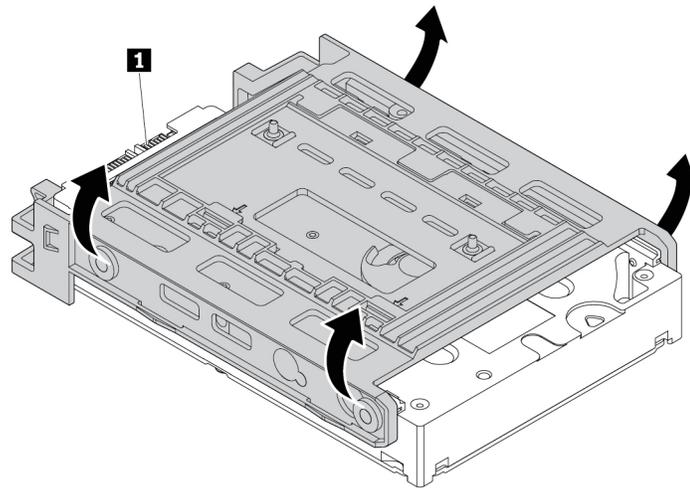
Abbildung 57. Entfernen des Speicherlaufwerks aus der Adapterhalterung
