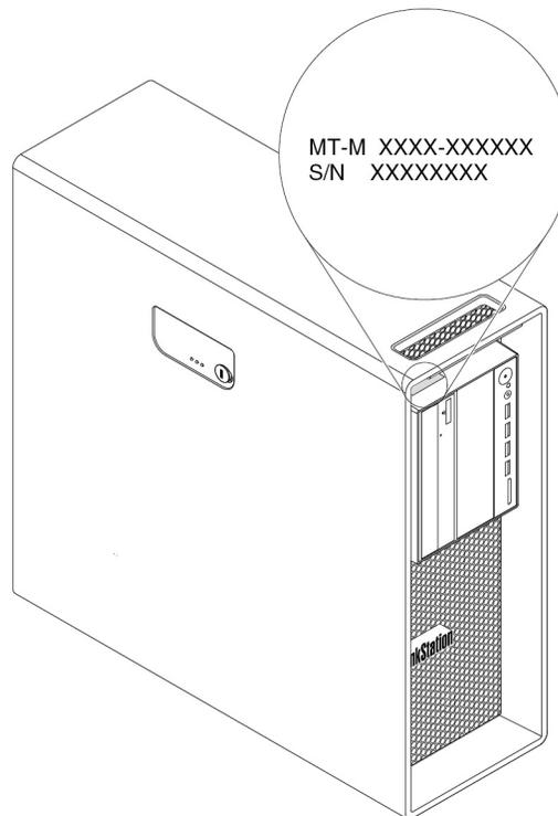
Abbildung 6. Etikett für Maschinentyp und -modell
