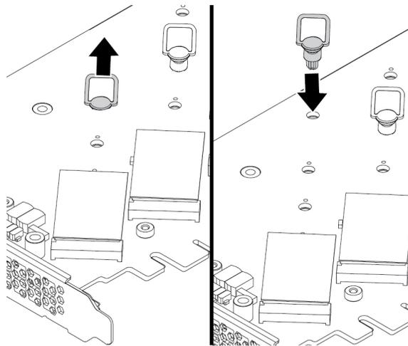
Abbildung 94. Anpassen der Position der Sicherung am PCIe-Adapter
