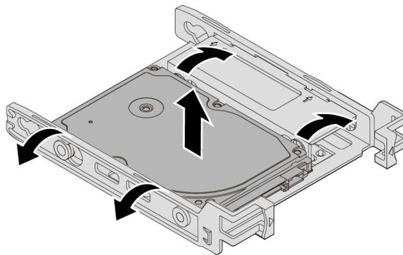
Abbildung 46. Das 2,5-Zoll-Speicherlaufwerk aus der Halterung entfernen
