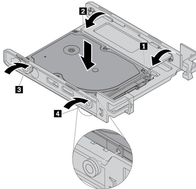
Abbildung 70. Installieren des neuen 2,5-Zoll-Speicherlaufwerks in der Halterung
