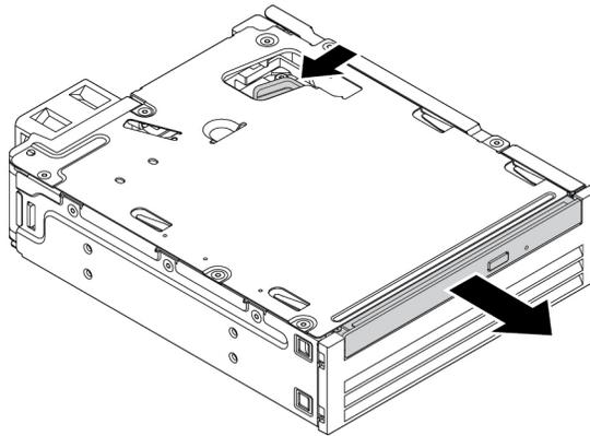
Abbildung 30. Flaches optisches Laufwerk aus dem Kit entfernen
