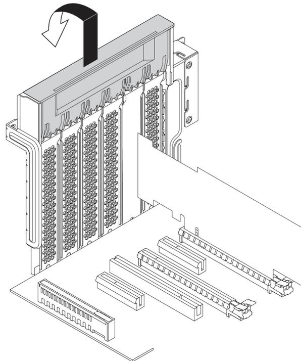
Abbildung 104. PCIe-Kartenverriegelung öffnen
