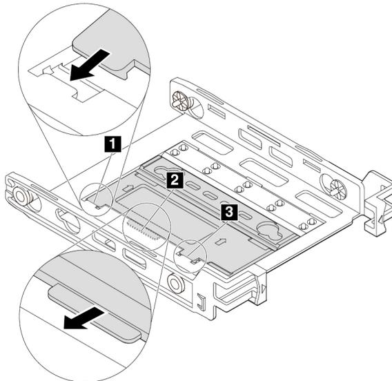
Abbildung 40. Einsetzen der Laschen in die entsprechenden Steckplätze
