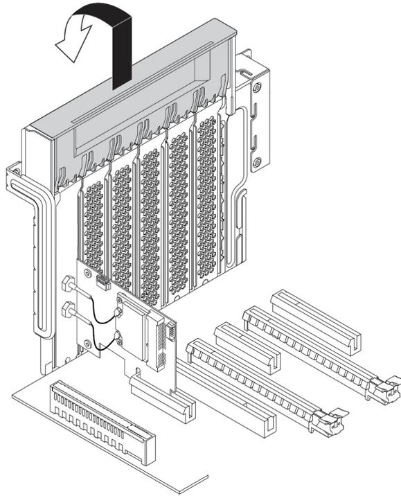
Abbildung 128. PCIe-Kartenverriegelung öffnen
