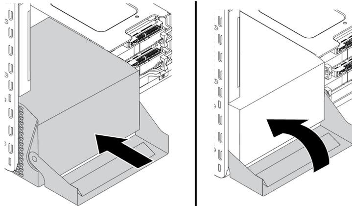
Abbildung 100. Netzteil installieren
