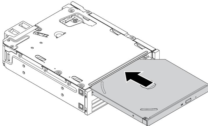
Abbildung 33. Flaches optisches Laufwerk in das Kit einsetzen
